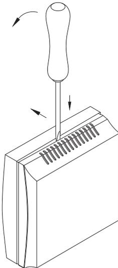
Zum Öffnen des Gehäuses einen Schraubendreher (2,0) in die Nut mittig ansetzen, nach unten drücken und den Bodenrahmen etwas anheben. Den Deckel nach vorne ziehen und halten.
